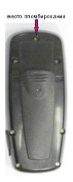
Рисунок 1 - Общий вид и схема пломбирования газоанализаторов СЕАН-П
