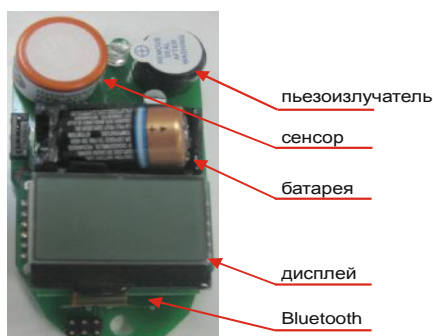
Рис.2. Фотография внутренней конструкции газоанализатора СЕАН.
